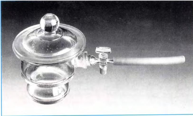
Рис. 21: Вакуумный сушитель
