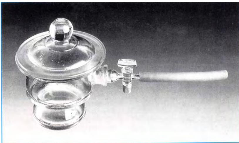
Рис. 21: Вакуумный сушитель
