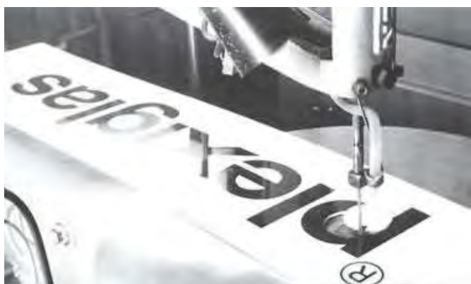
Рисунок 9 - Выпиливание лобзиком логотипа PLEXIGLAS
