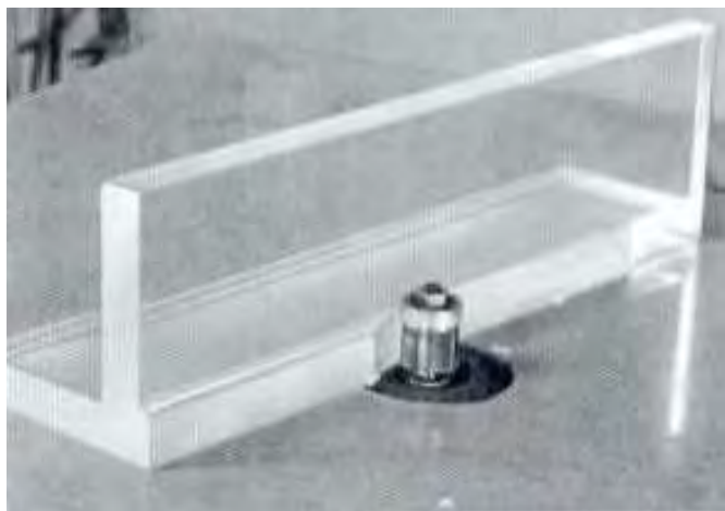
Рисунок 22 - Удаление клеевой кромки фрезерованием
