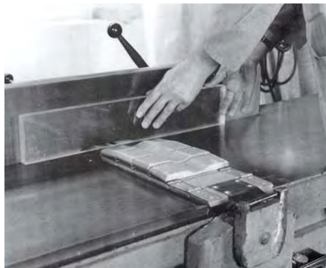
Рисунок 36 - Сглаживание торца на продольно - строгальном станке
