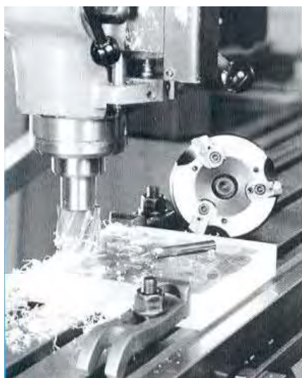
Рисунок 24 - Фрезерование PLEXIGLAS торцевой фрезой; различные другие типы фрез: (а) двух- кромочная фреза; (b) цилиндрическая фреза; (с) алмазная фреза
