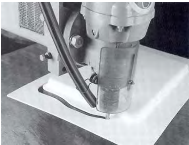
Рисунок 25 - Обрезка отформованной детали методом фрезерования по шаблону
