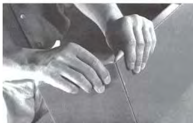
Рисунок 11 - Нанесение бороздки и поломка
